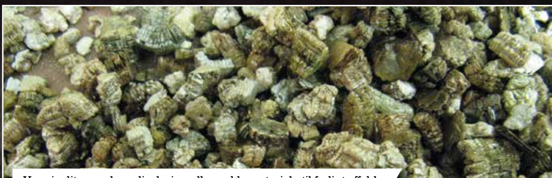
Vermiculite som brandisolering eller pakkemateriale til farligt affald.
